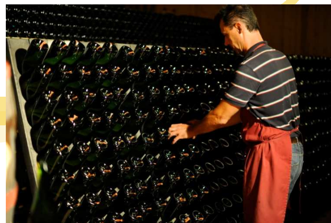
2次発酵では、酵母と糖分が片寄らないよう、 毎日手作業で4分の1回転します
